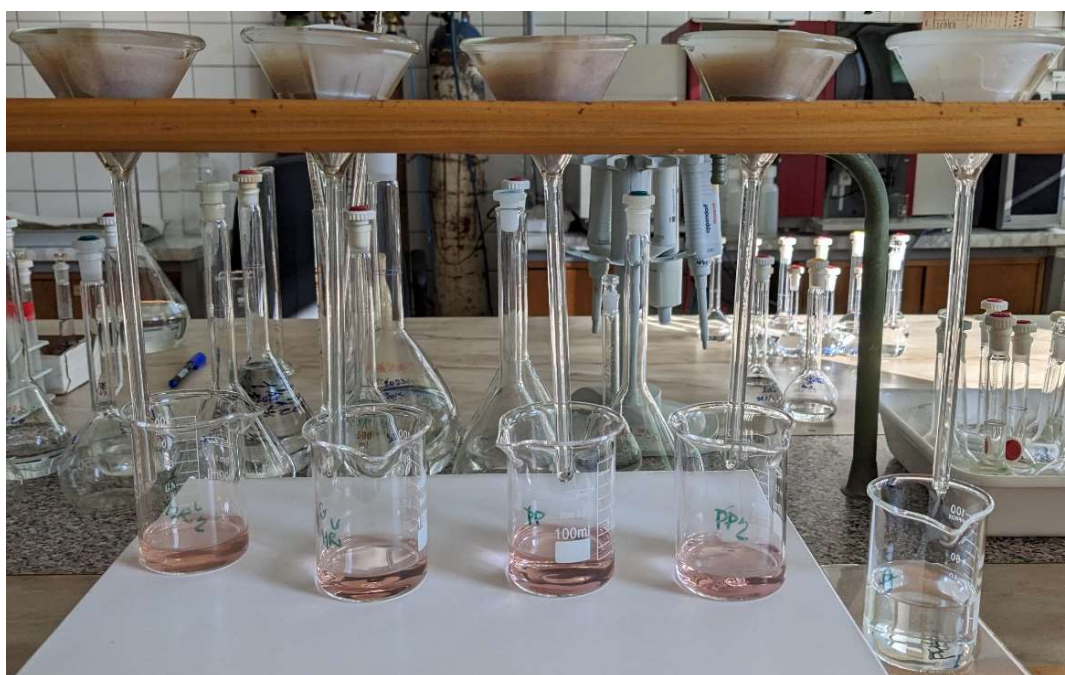
Obrázek 12: Sestavená filtrační aparatura – dva vzorky ve dvou opakování a blank.
