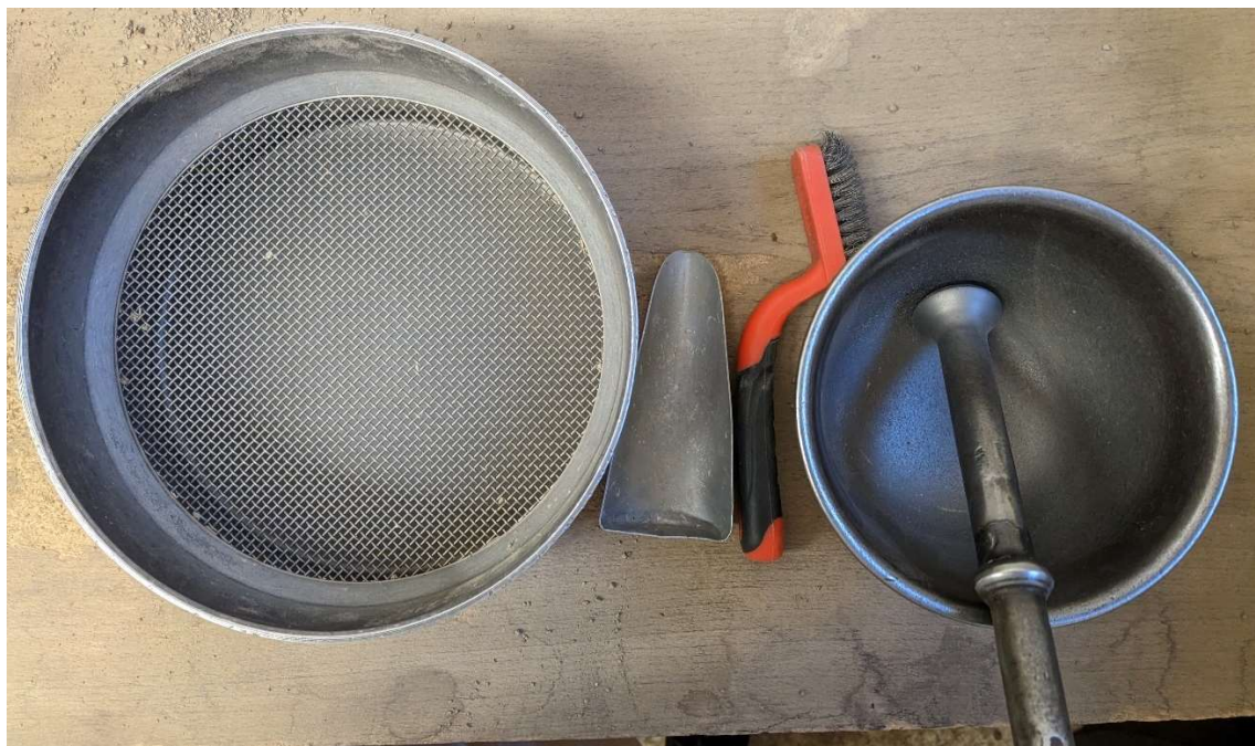
Obrázek 9: Použité náčiní pro přípravu jemnozemě v laboratoři (síta, lžíce, kartáč, hmoždíř).
