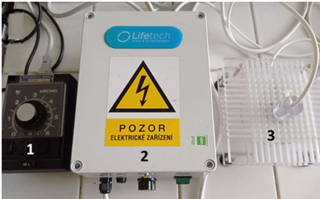
Obrázek 20: Laboratorní sestava pro přípravu PAW: 1 – nastavení času, 2 – zdroj, 3 – Petriho misky s elektrodami.
