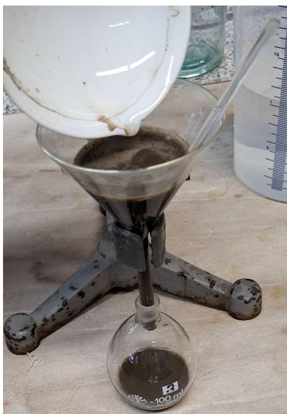
Obrázek 10: Kvantitativní převedení vzorku do pyknometru.
