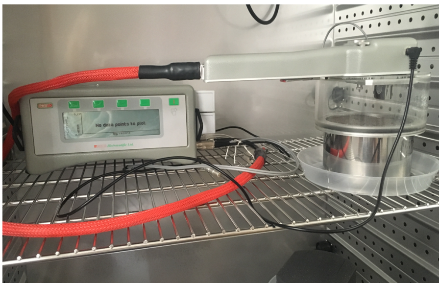
Obrázek 7 - Systém LCi-SD portable photosynthesis s komorou pro měření půdní respirace (zdroj vlastní)
