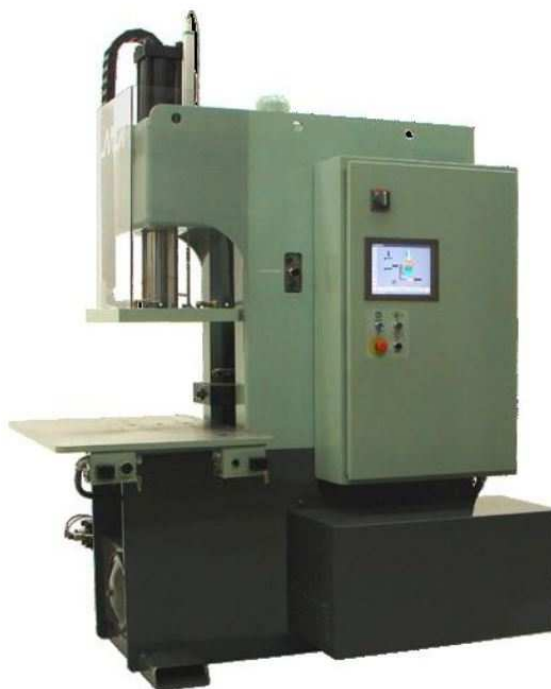
Obrázek 12 vstřikovací stroj MPI 55-100-38, C rám [9]
