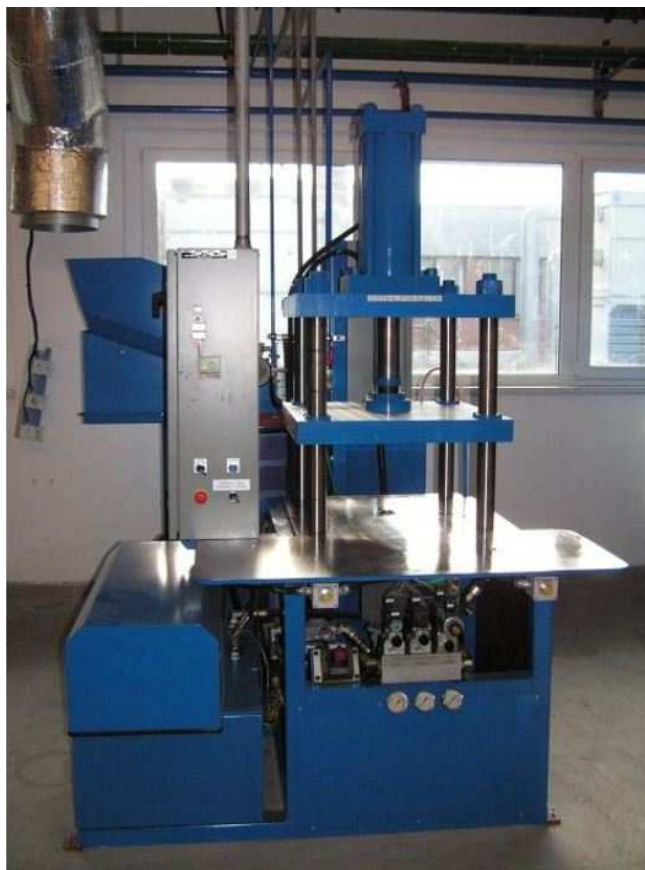
Obrázek 13 vstříkovací stroj Shell-O-Matic 35 T-20/28
