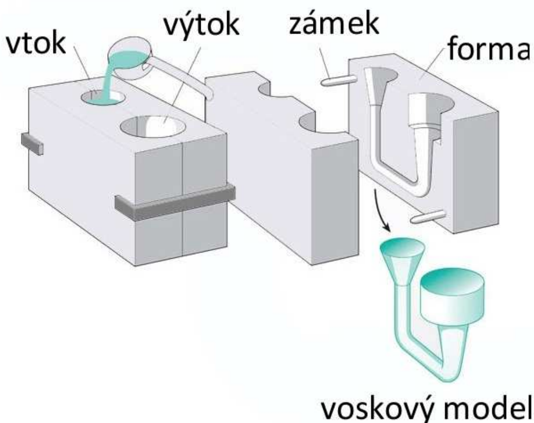
Obrázek 5 Schéma výroby voskového modelu gravitačním litím [8]
