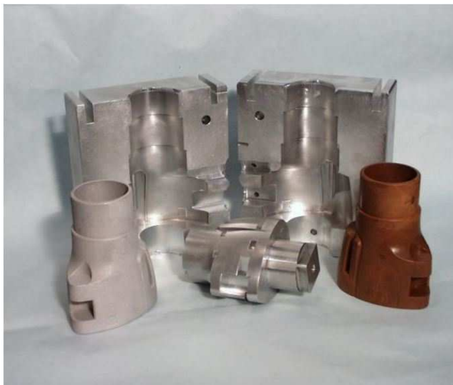
Obrázek 4 Forma vyrobená obráběním [6]
