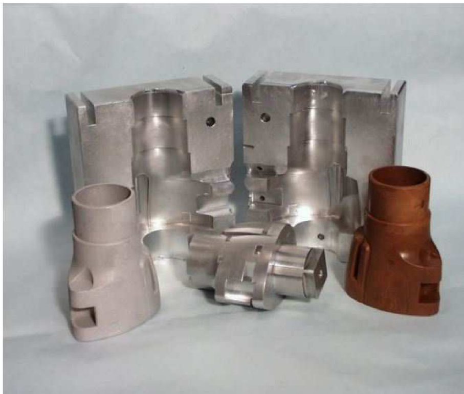
Obrázek 4 Forma vyrobená obráběním [6]
