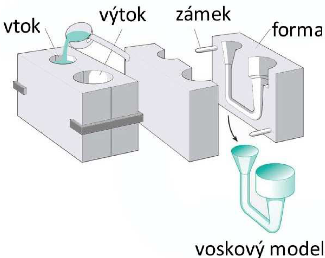
Obrázek 5 Schéma výroby voskového modelu gravitačním litím [8]
