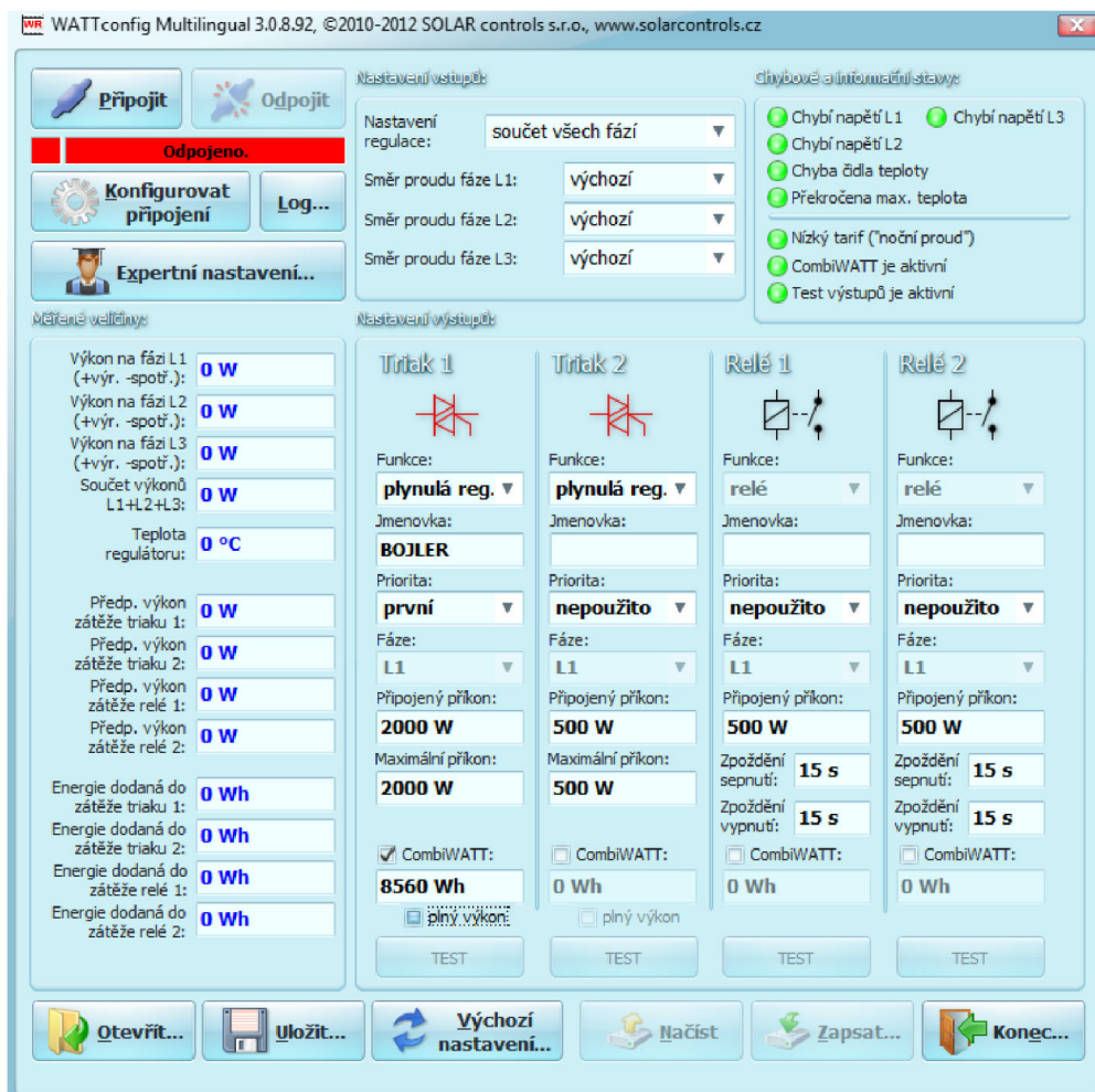
Obr. 6.5: Příklad nastavení programu WATTconfig při zapojení bojleru, převzato z [24]
