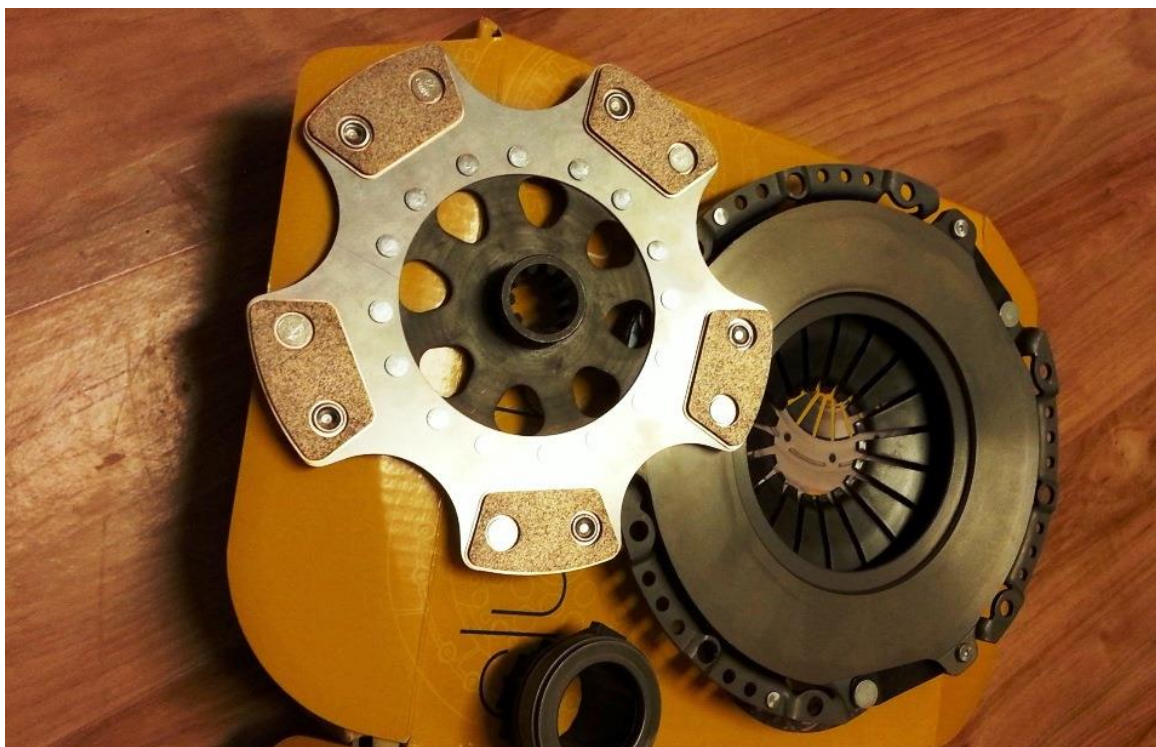
Obrázek 5.4: Spojková sada, schopná přenést větší točivý moment
