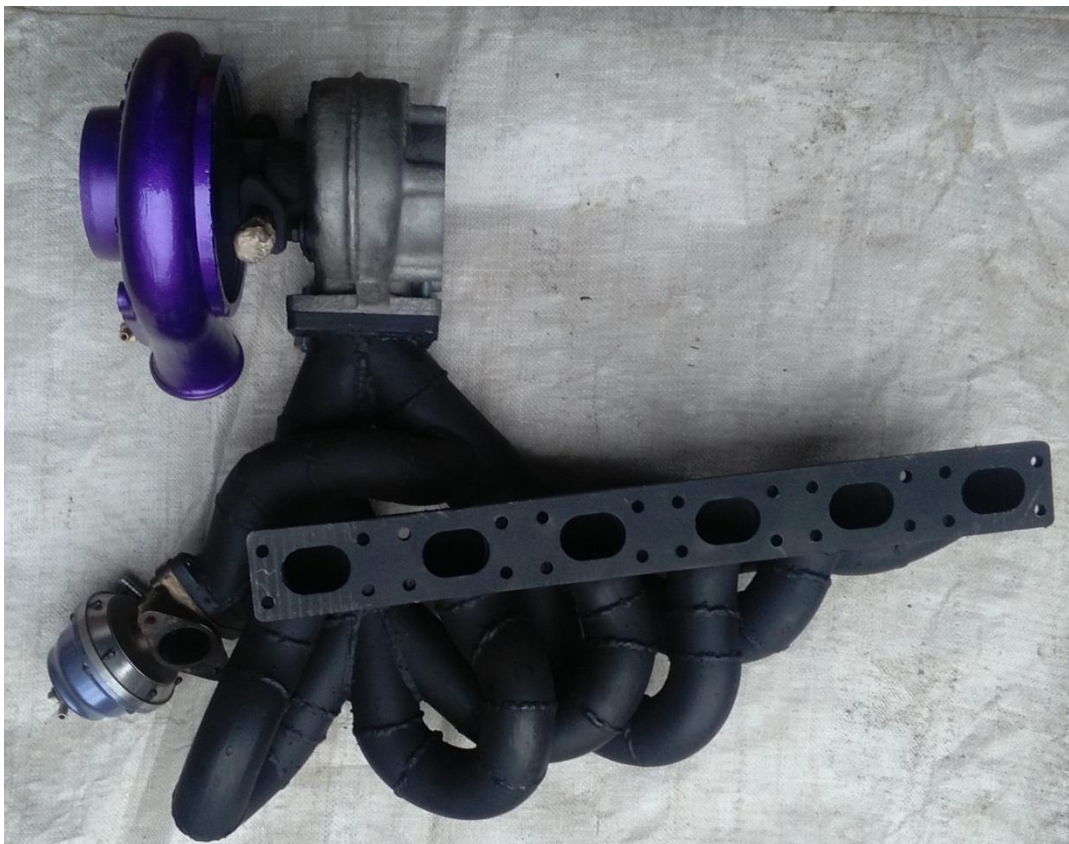
Obrázek 5.1: Výfukové svody s turbodmychadlem Holset HX35 a externím wastegate
