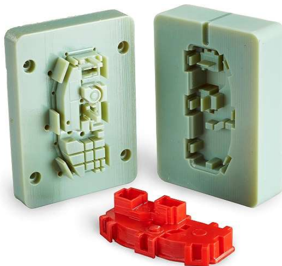
Obr. 19 Forma vyrobená aditivní technologií PolyJet [42].
