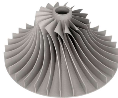
Obr. 27 Turbína vyrobená metodou SLM [66].
