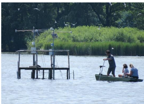
Obrázek 13 - Odběr vzorku sedimentu komorovou sondou lokalita A a pohled na telemetrickou stanici. (Foto: Procházka, 2019)
