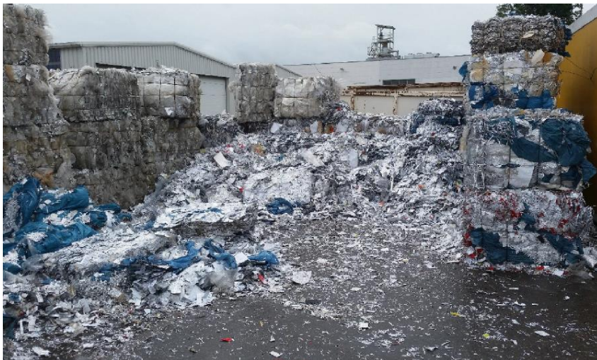
Obrázek 22: Drcené OFB na velikost 20 mm (LCA studie, 2017)
