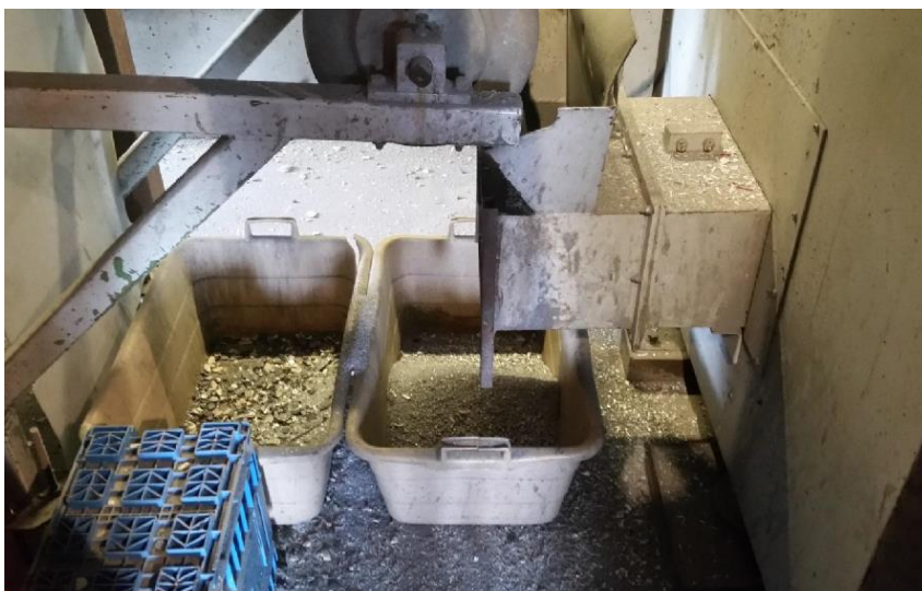
Obrázek 23: Delaminace pomocí vysokorychlostní rotace (LCA studie, 2017)
