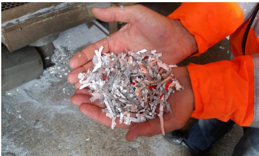
Obrázek 23: Delaminace pomocí vysokorychlostní rotace (LCA studie, 2017)
