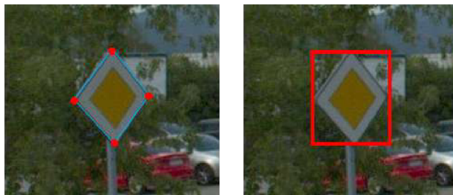
Obrázek 5.3: Příklad anotace dopravní značky z použité datové sady pomocí dvou metod. Vlevo je objekt anotován pomocí keypoints , vpravo pomocí bounding boxu . Lze si povšimnout, že anotace pomocí keypoints poskytuje na rozdíl od bounding boxu informace o přesné poloze značky v prostoru.
