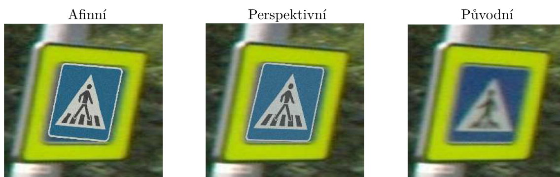
Obrázek 5.4: Ve většině případů je použití afinní transformace sloužící k projekci dvou-rozměrného objektu na rovinu postačující. Avšak v některých případech, kdy je zachycená značka blízko kameře a na snímku je znatelný její třetí rozměr, neposkytuje dostatečně kvalitní překrytí původní značky.
