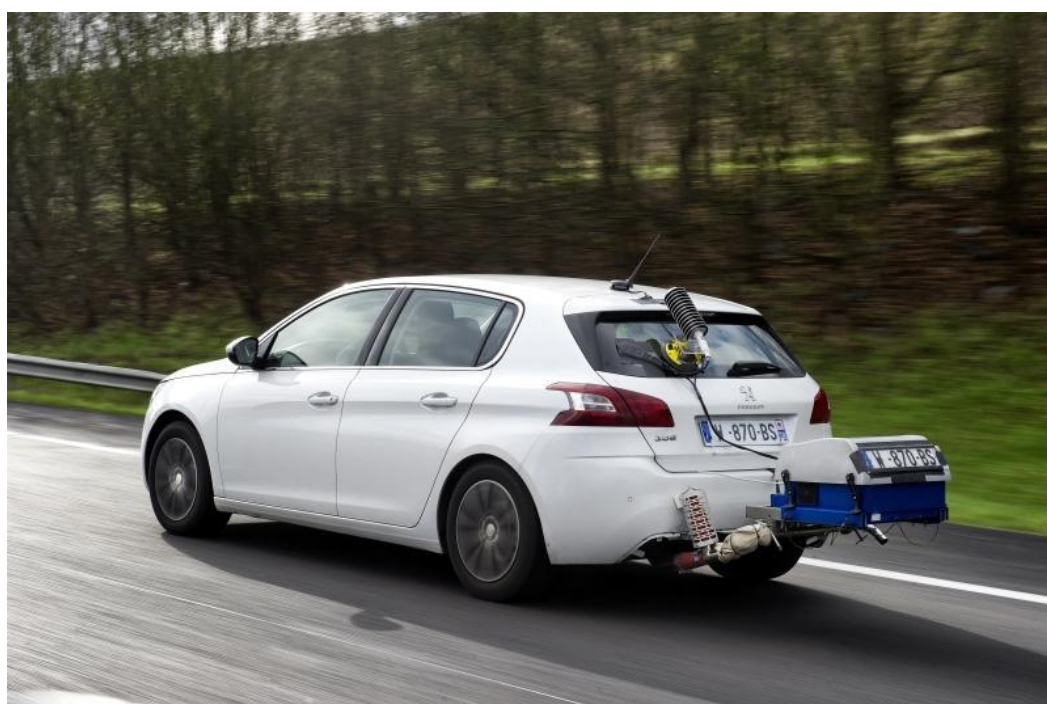
Obr. č.10 - Měření emisí v reálném provozu metodou RDE, převzato z [18]
