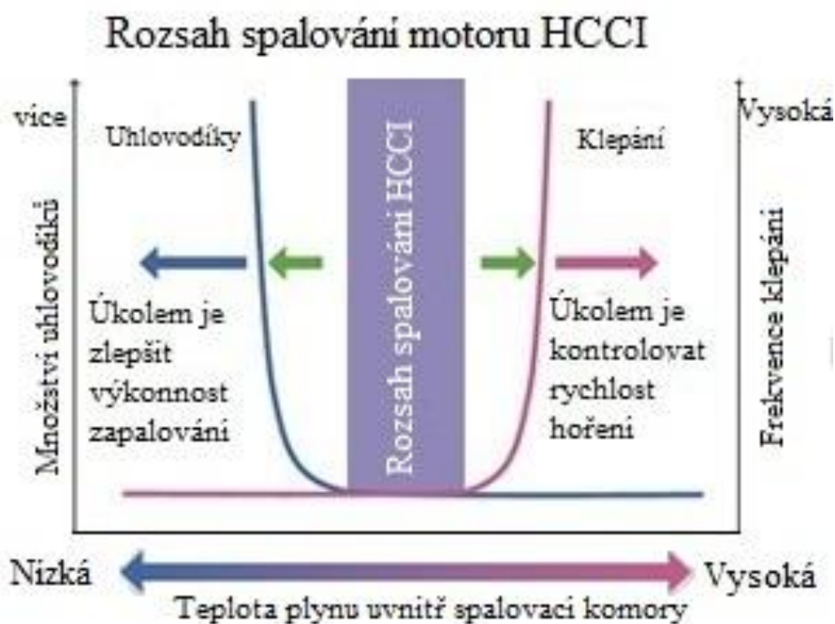
Obr. č.20 - teplotní rozsah spalování u motoru HCCI, převzato z [15]
