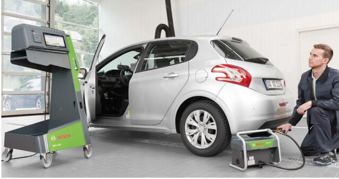
Obr. č.29 - Emisní systém Bosch BEA 750 s analyzátořem Bosch BEA 065 , převzato z [20]
