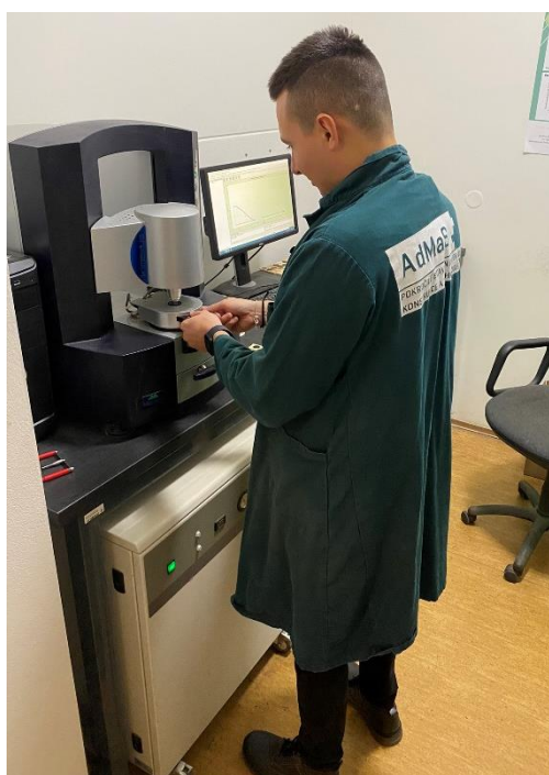
Obrázek č. 36: Nahřívání vzorku na zkušební teplotu na dynamickém smykovém reometru
