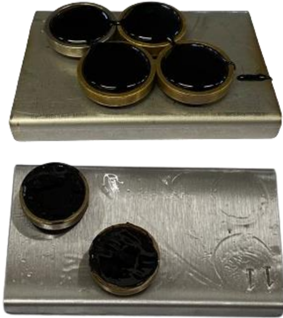
Obrázek č. 29: Příprava zkušebních vzorků pro zkoušku stanovení bodu měknutí
