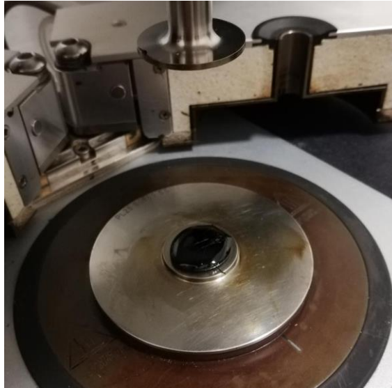
Obrázek č. 34: Vzorek asfaltového pojiva umístěn do přibližného středu reometru [77]
