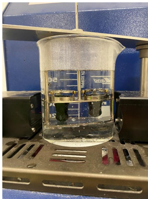
Obrázek č. 30: Provádění zkoušky stanovení bodu měknutí
