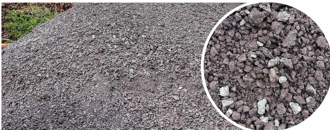
Obrázek č. 2: Vyfrézovaná znovuzískaná asfaltová směs [6]
