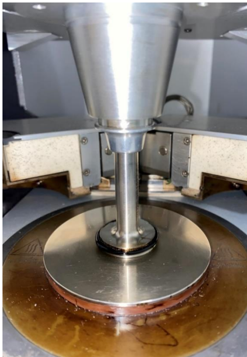
Obrázek č. 35: Stlačený vzorek asfaltového pojiva (vlevo) a seřiznutý vzorek (vpravo)
