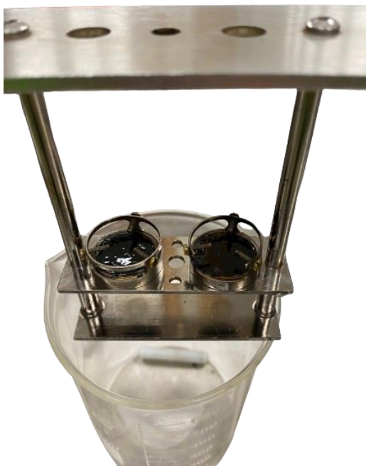
Obrázek č. 30: Provádění zkoušky stanovení bodu měknutí
