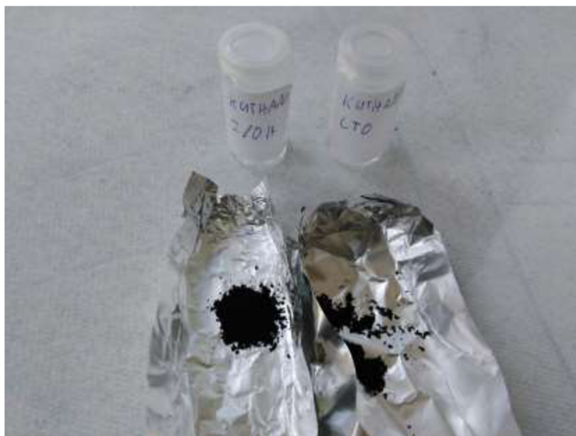
Obrázek 21: aktivní hmota LTO a 280H
