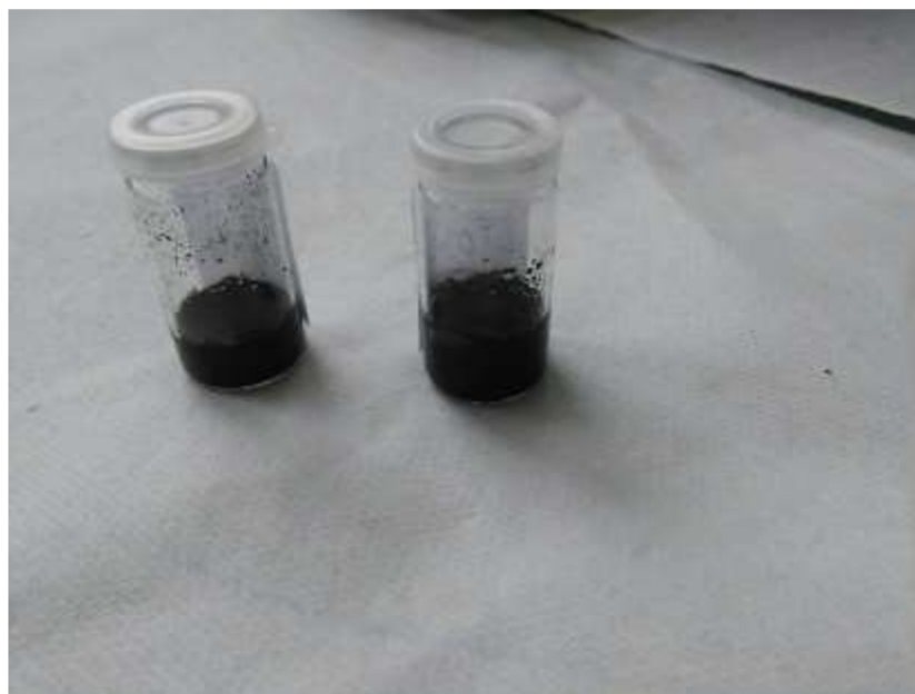
Obrázek 22: promíchané materiály LTO a 280H
