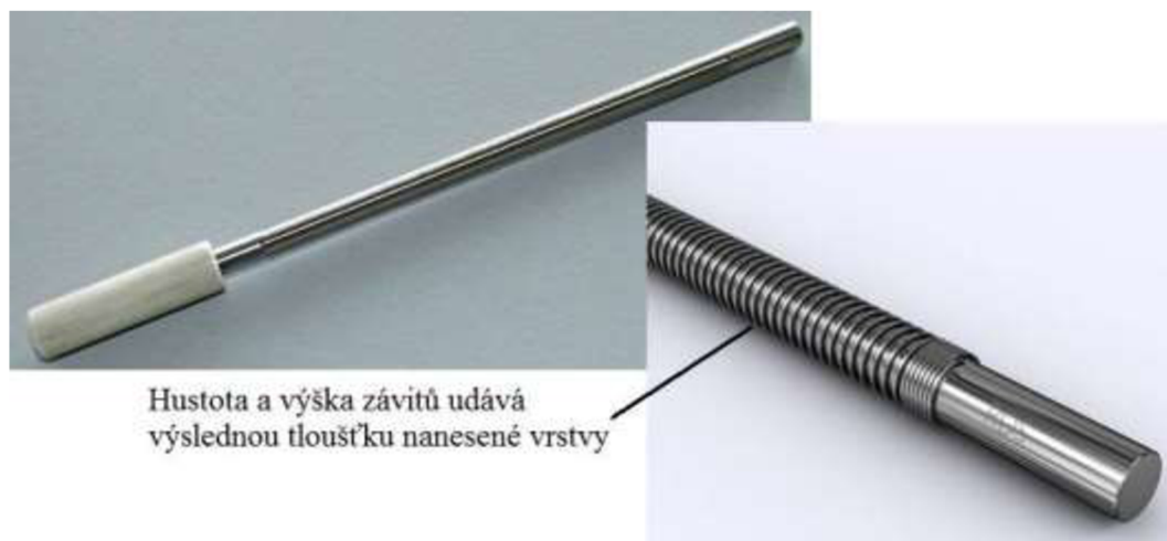
Obrázek 23: tyč pro nanášení přesně definované vrstvy elektrodové hmoty
