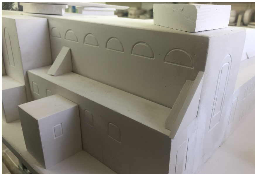
Obr. 21: Vkládání sádrových klínů pod střešní krytinu.
