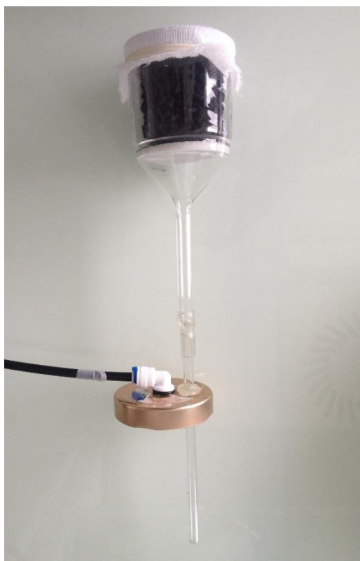
Obr. 12 Víko vzorkovnice s nasáváním přes uhlíkový filtr
