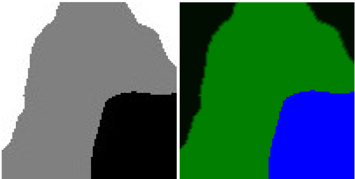
Obrázek 5.4: Obrázek nalevo ukazuje šedotónový obrázek představující výškovou mapu pro terén, který je na pravém obrázků. Šedotónový obrázek má rozměry 100 \times 100 a terén 24000 \times 24000 .
