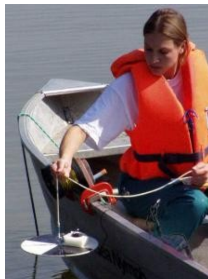
Obrázek 12: Měření průhlednosti pomocí seccioho desky Zdroj: Povodí Labe 2019a
