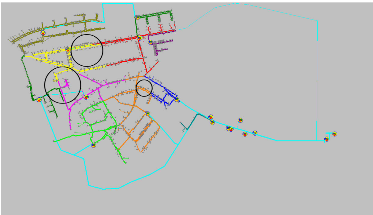
Obr. 7-1 Upravená topologie distribuční soustavy zvolené obce
