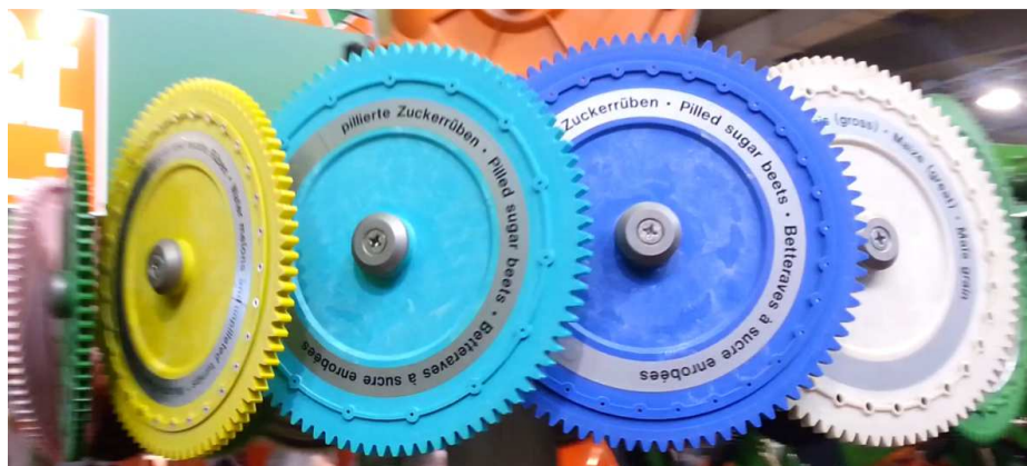
Obrázek 7 – Varianty výsevních kotoučů
