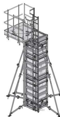
Obr. 20 – osazení sloupové plošiny
