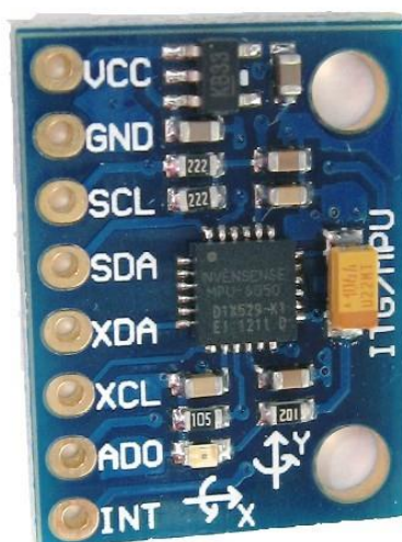
Obrázek 6 – Modul s akcelerometrem MPU6050, převzato z [9].
