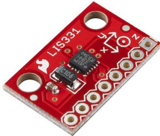
Obrázek 5 – Modul s akceleromterem LIS331, převzato z [8].
