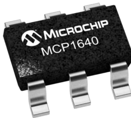
Obrázek 13 – Microchip MCP1640, zdroj [18]
