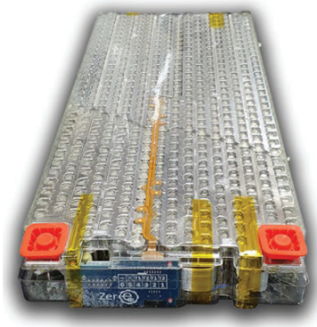
Obrázek 20: Ukázka modulu s implementací chlazení obsahujícím válcové články [24]
