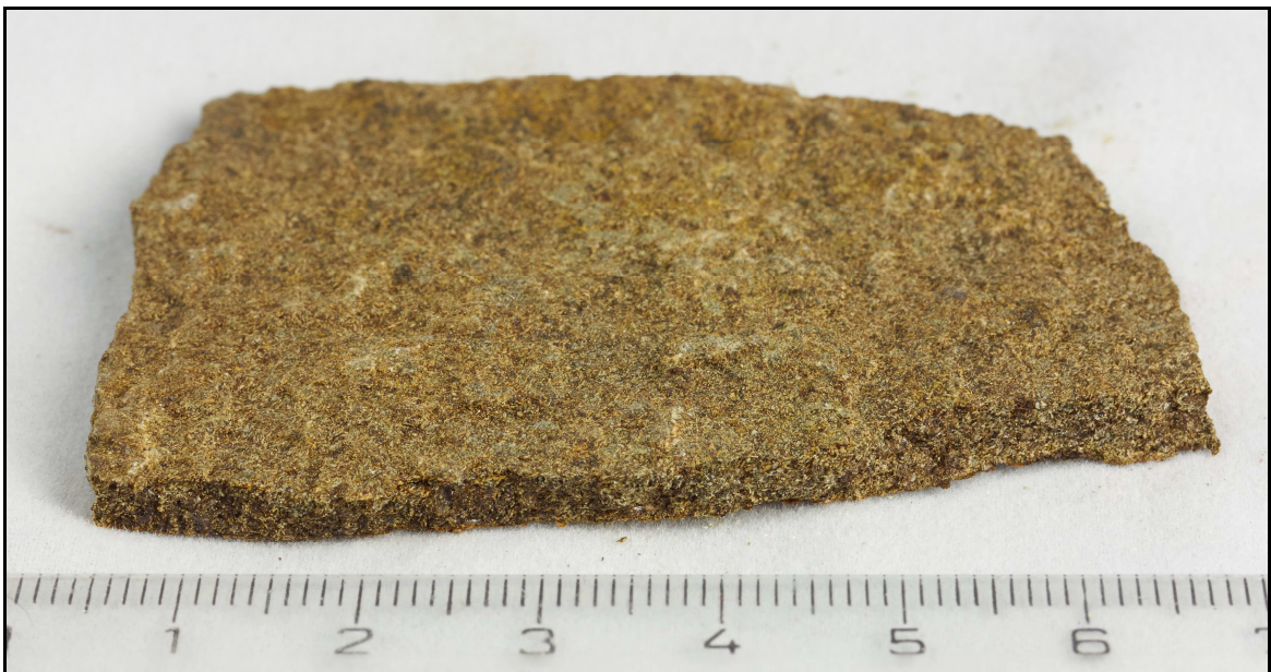
Obr. 45: Odebraný vzorek navětralé spáry (foto V. Šobáň, 2. 3. 2018)
