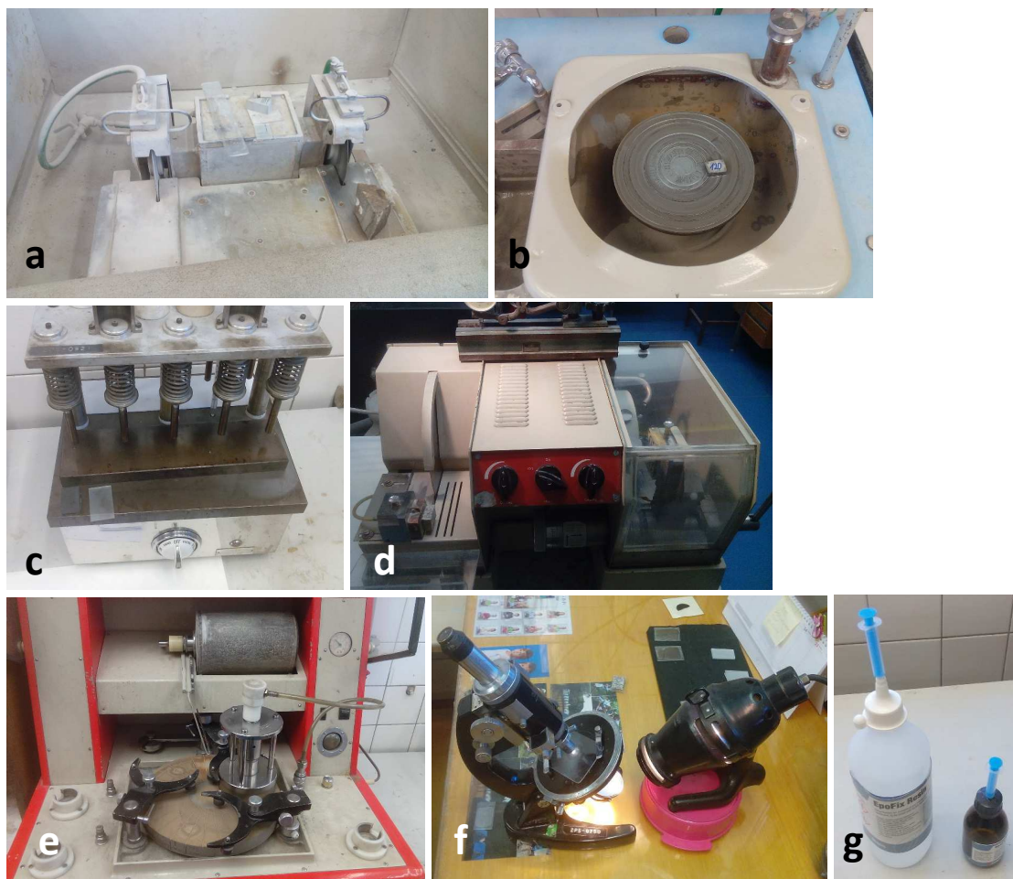
Obr. 4: Diamantová pila (a), brus BMG-1 (b), svěrky s podložním sklíčkem (c), diskoplán s frézou (d), brusný kotouč LP30 (e), mikroskop Meopta 103564 (f), EUKIIT (g)
