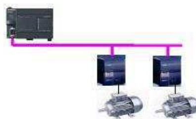
Obr. 25. Řízení USS protokolem
