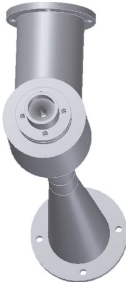
Obr. 32 Paroproudá vývěva – pohled zezadu
