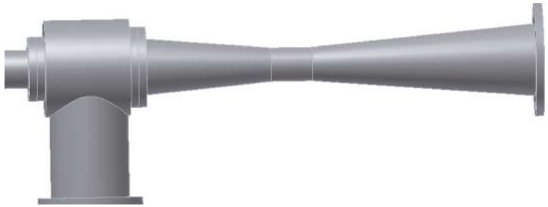
Obr. 31 Paroproudá vývěva – boční pohled
