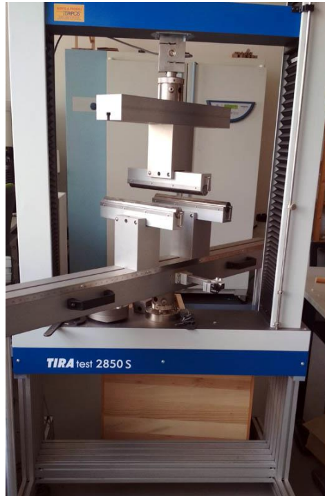
Obrázek 16: UTS Tira v konfiguraci pro třibodový ohyb
