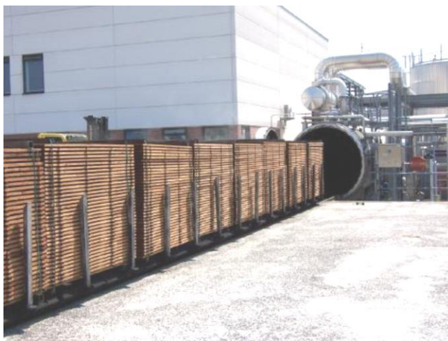
Obr. 49 Průmyslové zařízení pro hydrotermolytické úpravy v první fázi ( www.platowood.nl )
