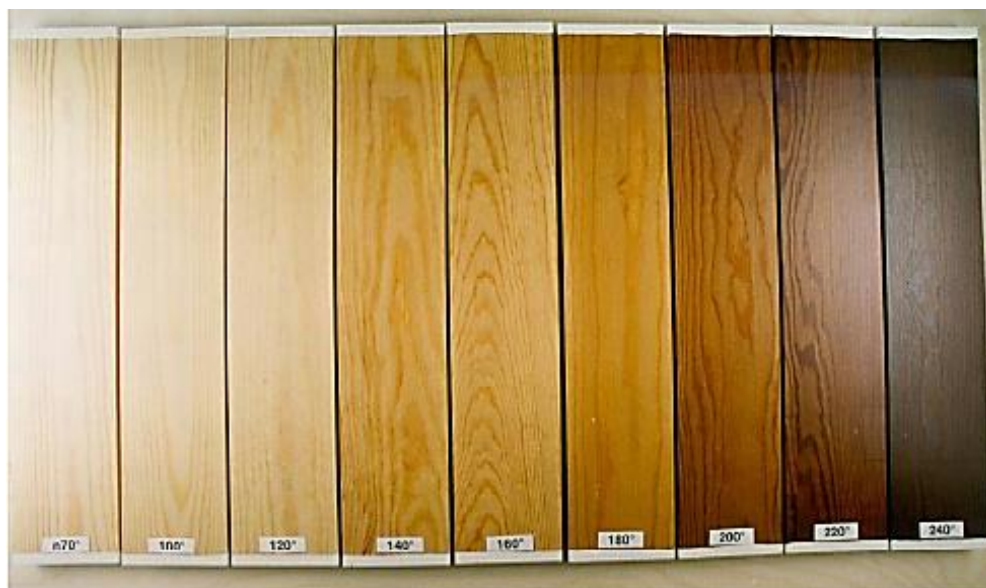
Obr. 8 Barva tepelně upraveného borovicového dřeva. Teplota upravování začíná na 70°C a dále se pohybuje od 100°C do 240°C po 20°C intervalech. Čas tepelného upravování je 3 hodiny. (ThermoWood Handbook, 2003)
