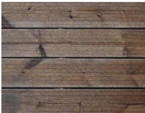
Obr. 19 Barevné změny ve fázi začínajícího procesu šednutí – viditelné přirozené mapky připomínající vznikající plíseň (www.prokom.cz)
