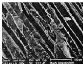
Obr. 4 Mikroskopická struktura tepelně upraveného dřeva borovice (ThermoWood Handbook, 2003)
