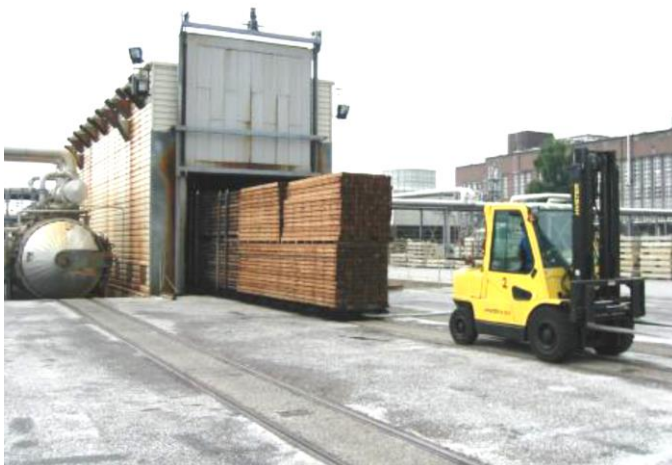
Obr. 51 Průmyslová sušárna používána pro vytvrzování ( www.platowood.nl )
