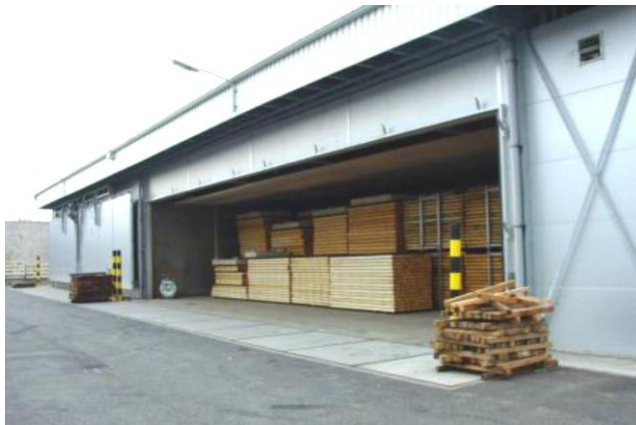
Obr. 50 Průmyslová sušárna pro sušení a kondenzování dřeva během tepelné úpravy ( www.platowood.nl )
