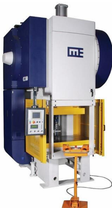
Obr. 45 Excentrický lis CC63 [26].
