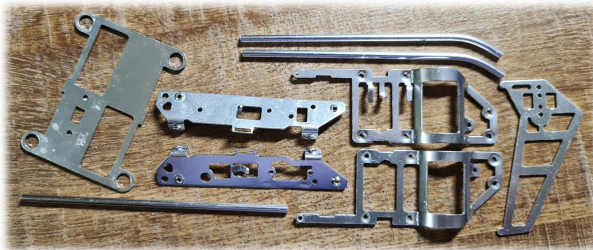
Obr. 4 Součásti RC vrtulníku vyráběné z hliníku.
