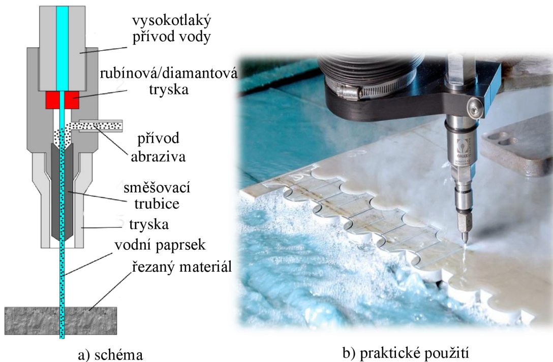
Obr. 6 Vodní paprsek [11; 12].
