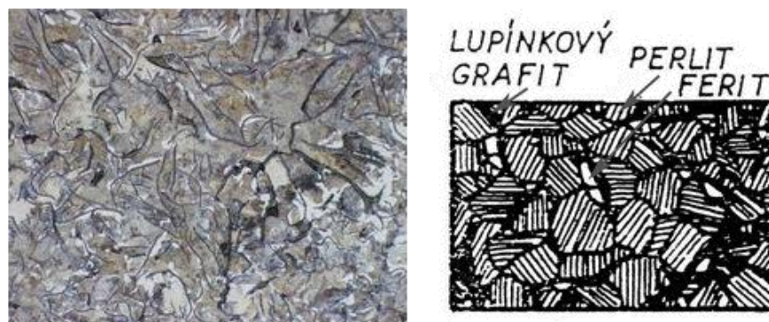
Obr. 1.5 Litina s lupínkovým grafitem s maticí feriticko-perlitickou
