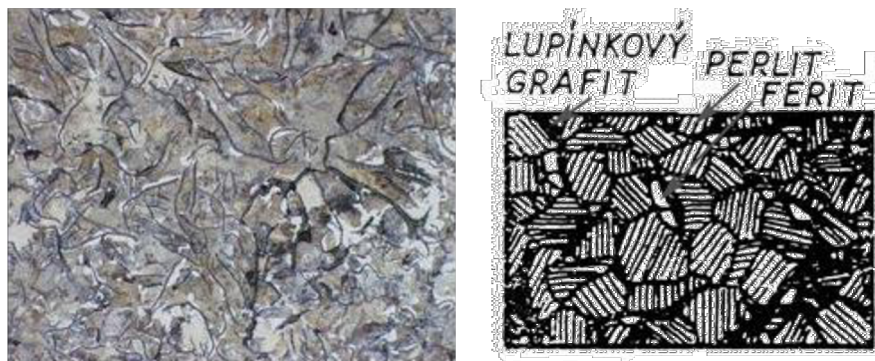
Obr. 1.5 Litina s lupínkovým grafitem s maticí feriticko-perlitickou
