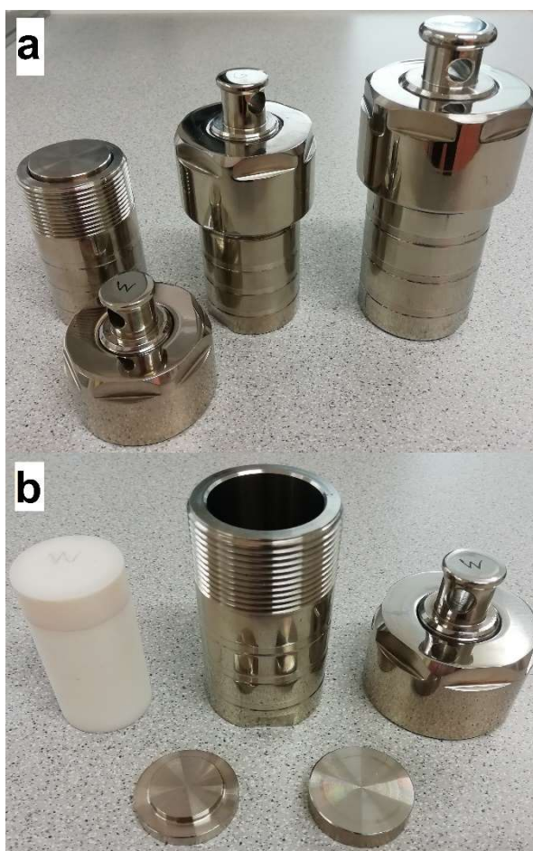
Obrázok 4.1: Použité autoklávy (a), rozložený autokláv (b)
