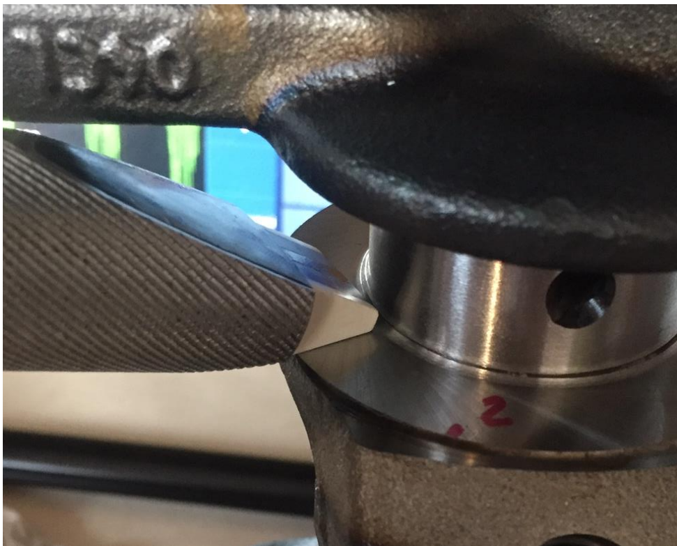
Obr. 4.7 Snímač pro měření boků ozubených kol č. 5912 ve styku s měřenou plochou
