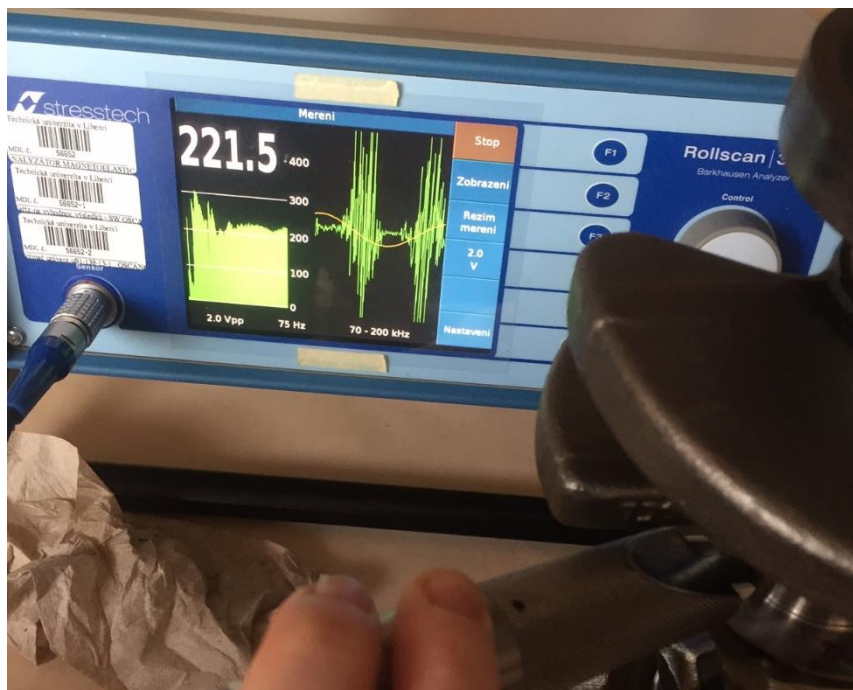
Obr. 4.6 Měřící přístroj Rollscan 300 při měření klikové hřídele
