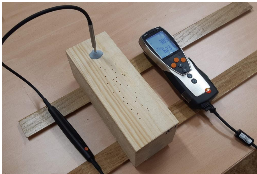
Obrázek 21 Měření sondou Testo 0636 2135 s použitím přístroje Testo 635-2
