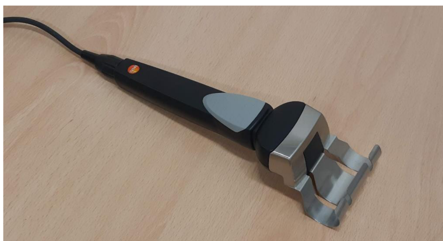
Obrázek 19 Kapacitní vlhkoměrná sonda Testo 0636 6160
