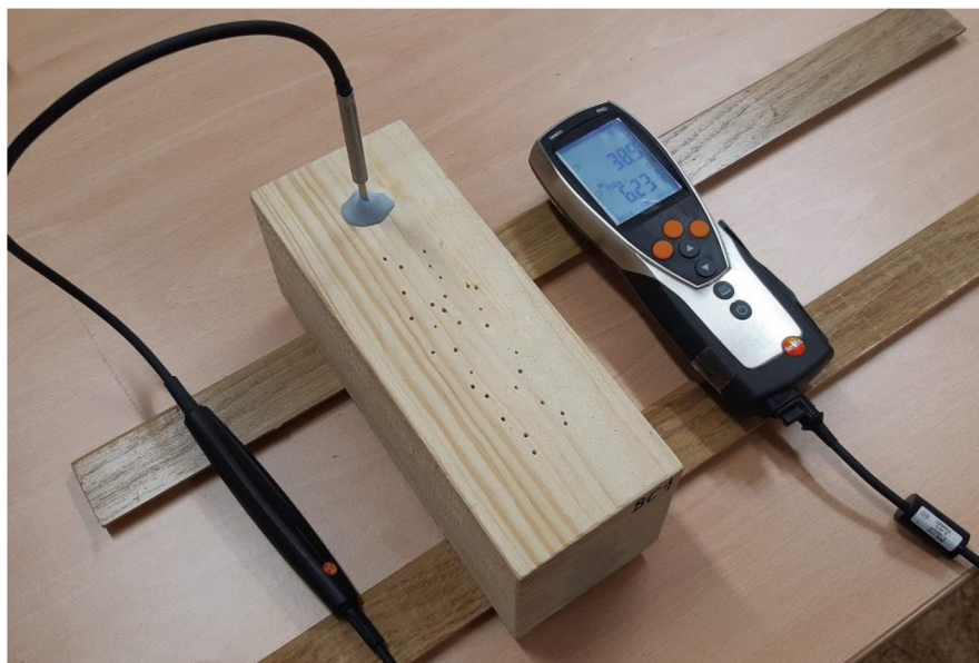
Obrázek 21 Měření sondou Testo 0636 2135 s použitím přístroje Testo 635-2
