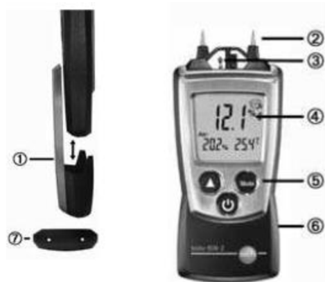
Obrázek 17 Popis odporového vlhkoměru Testo 606-2
