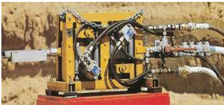
Obr. 5.56 Přístroj na mechanické navlékání předpínacích lan
