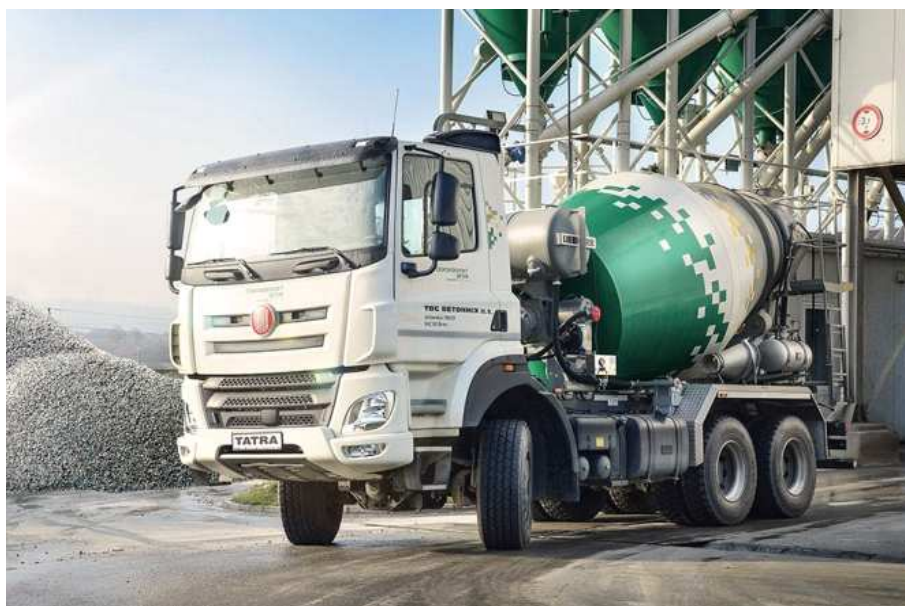
Obr. 5.40 Mobilní míchač Stetter AM 8 na podvozku Tatra Phoenix 6x6
