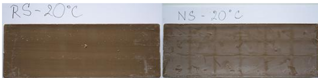
Obr. 14 Tukový výkvět na zátěru u RS a NS vzorků, 20 °C (šestý odběr)
