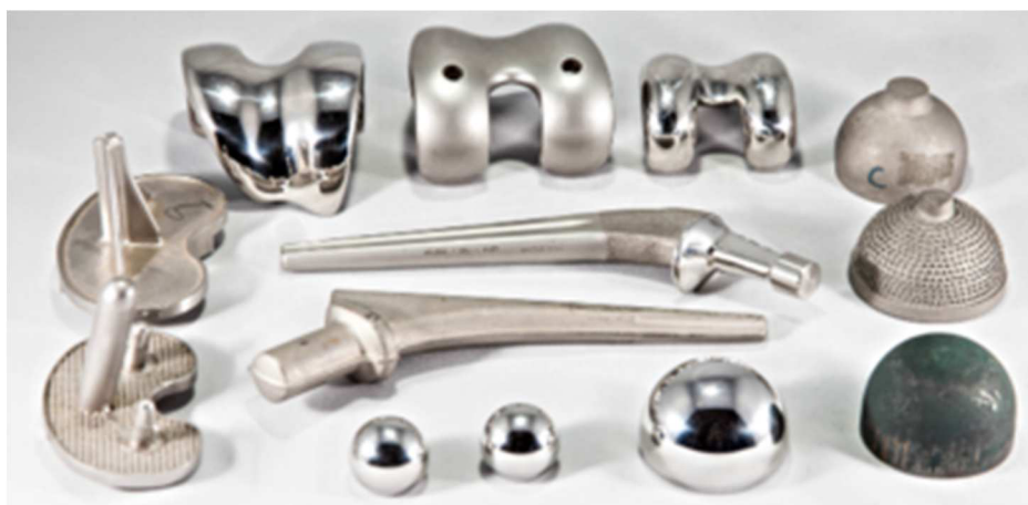
Obr. 37 Ukázka odlitků pro kloubní náhrady (fa United Superalloys)[42]
