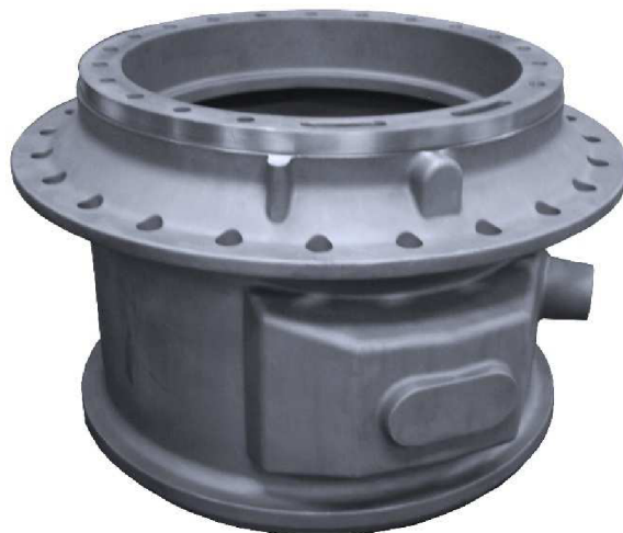
Obr. 23 Odlitek pro ložisko plynové turbíny (fa Miller Castings)[25]
