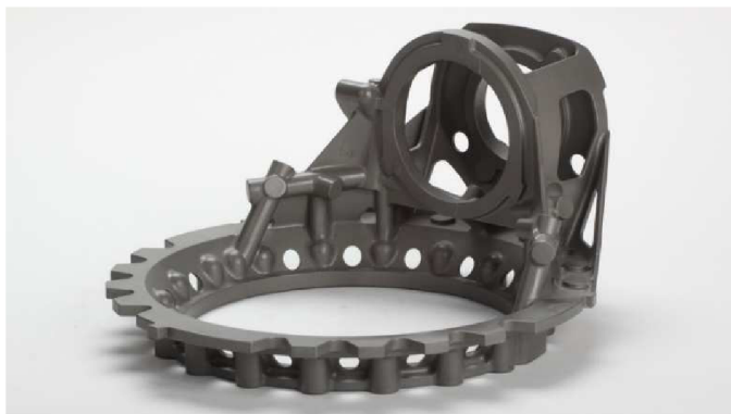
Obr. 18 Odlitek systému pomocného pohonu - ocel (fa Miller Castings)[25]
