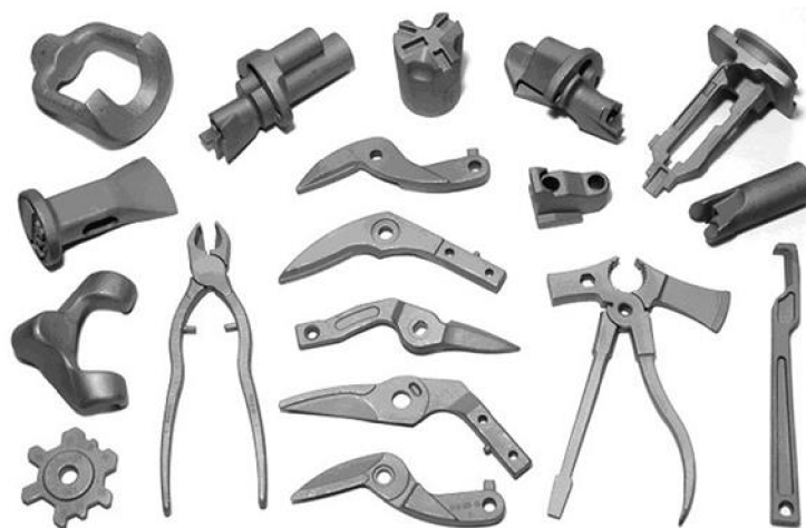
Obr. 20 Odlitky nářadí - fa Kdynium [27]
