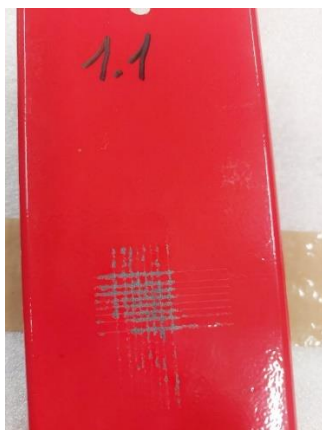
Obrázek 4.11: Provedení mřížkové zkoušky
