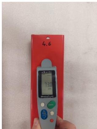
Obrázek 4.12: Měření tloušťkoměrem eXacto F
