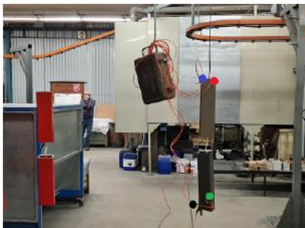
Obrázek 5.1: Praktická ukázka rozmístění sond při měření
