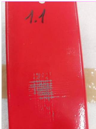
Obrázek 4.11: Provedení mřížkové zkoušky
