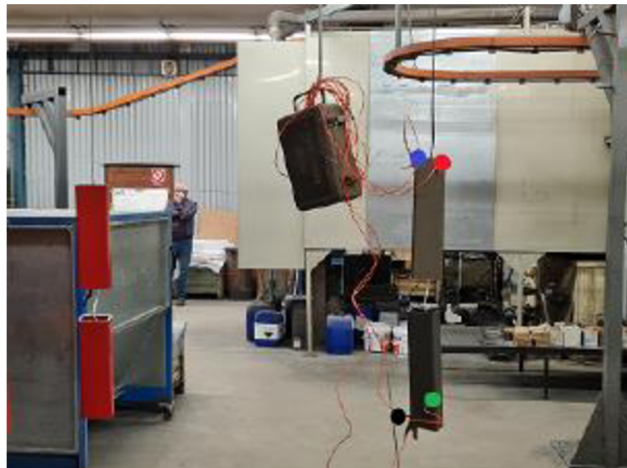
Obrázek 5.1: Praktická ukázka rozmístění sond při měření
