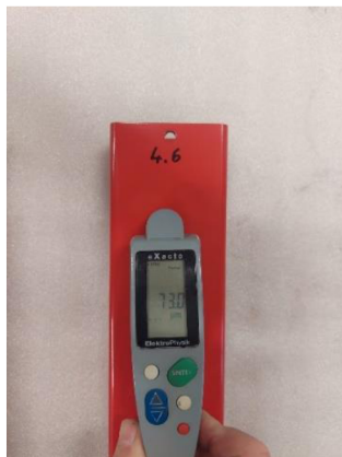
Obrázek 4.12: Měření tloušťkoměrem eXacto F
