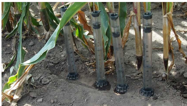
Obrázek 9: Mini Disk infiltrometry v porostu kukuřice Zdroj: vlastní
