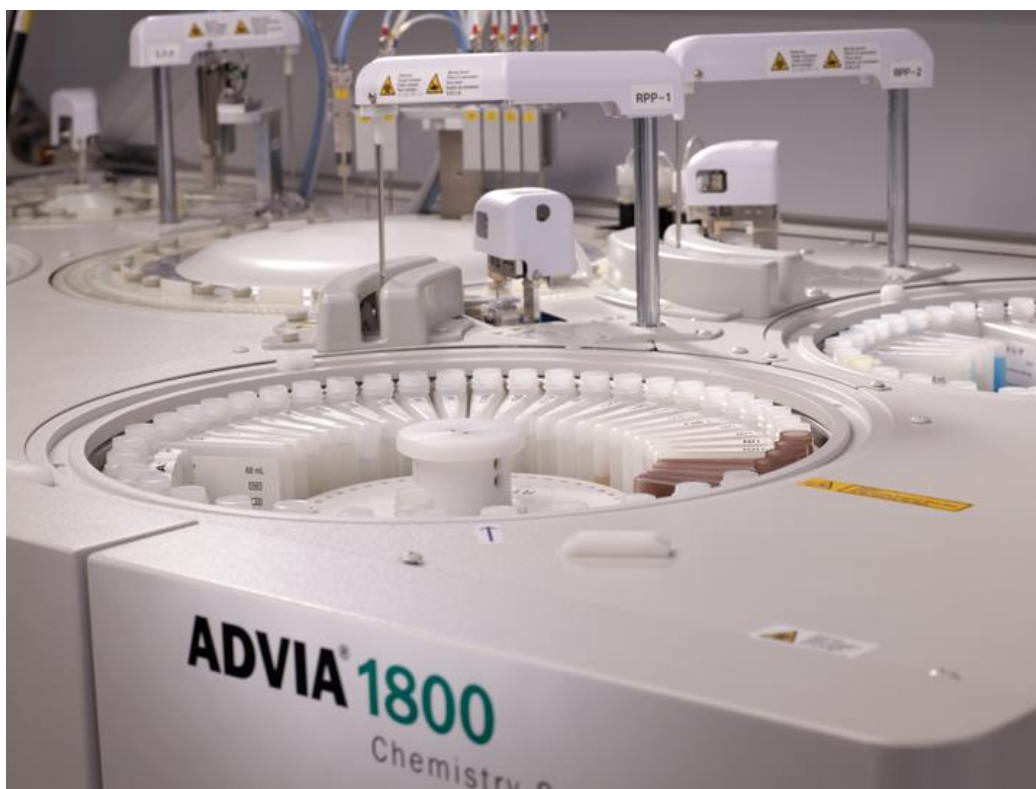
Obr. č. 45: Reagenční kola analyzátoru Siemens Advia 1800 [44]
