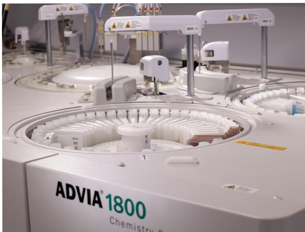
Obr. č. 45: Reagenční kola analyzátoru Siemens Advia 1800 [44]
