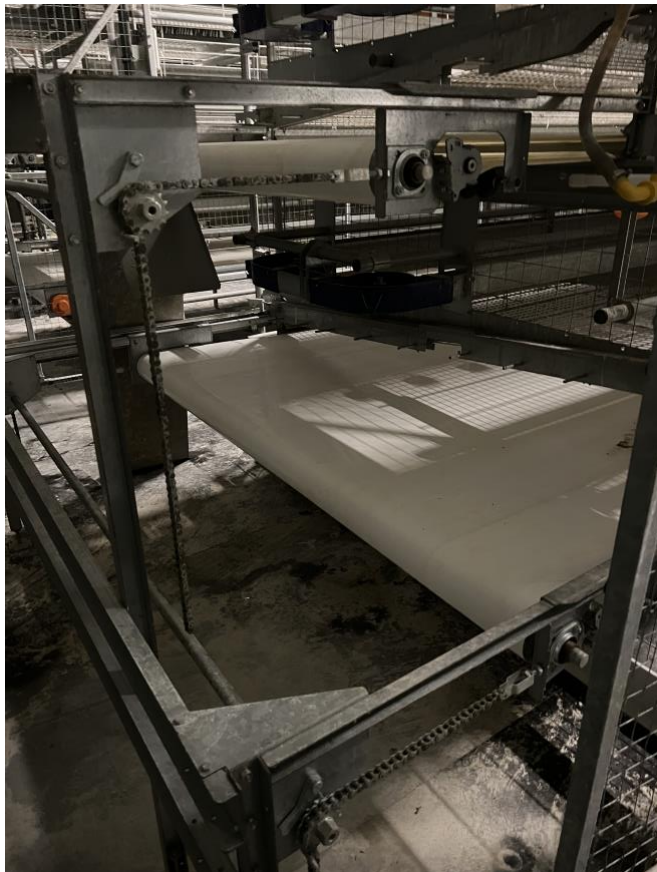
Obrázek 5: Pás na vývoz trusu na farmě v Brodě nad Tichou (vlastní fotografie)
