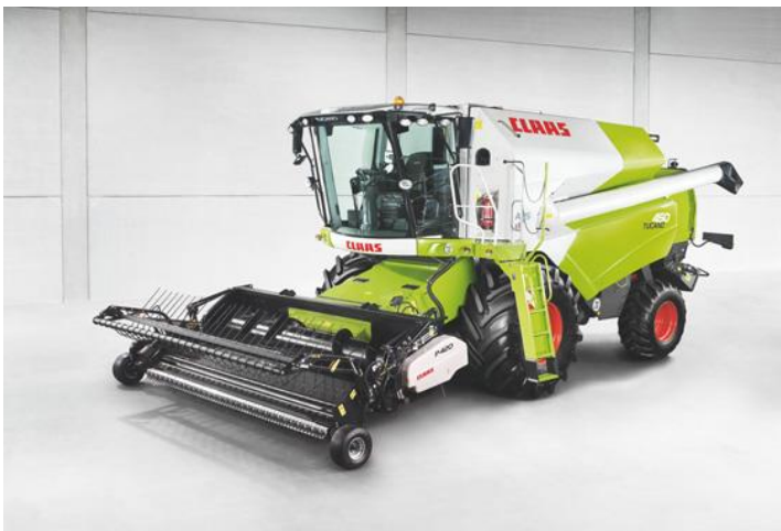
Obrázek II-6 Bubnové sběrací ústrojí, dostupné na http://claas.com [6]
