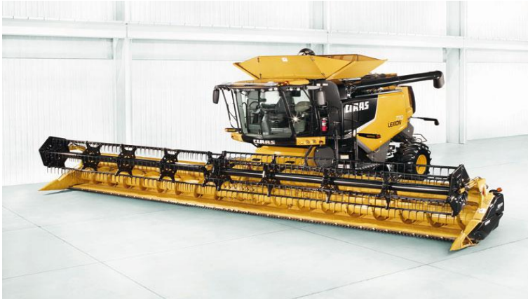
Obrázek II-5 Žací ústrojí pro přímou sklizeň, dostupné na http://app.claas.com [5]
