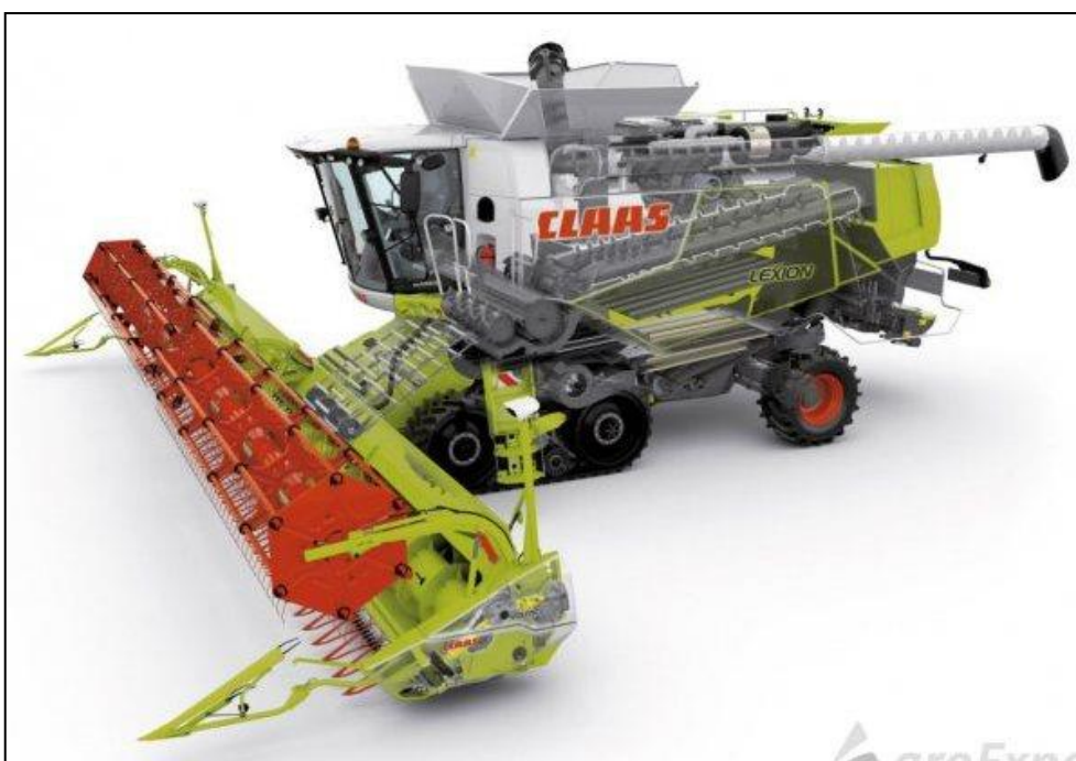
Obrázek V-3 Sklízecí mlátička Claas Lexion s pásovým podvozkem, dostupné na http://app.claas.com [5]
