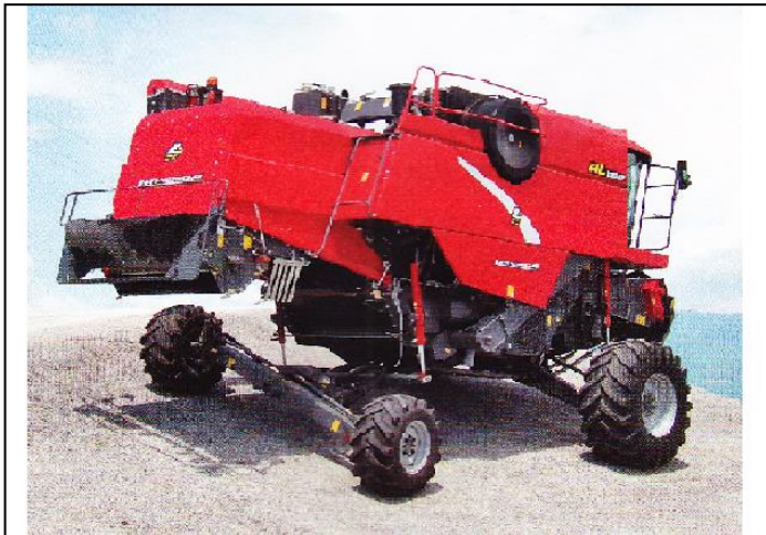
Obrázek II-23 Příčné a podélné vyrovnávání sklízecí mlátičky, dostupné na www.agromachinery.cz [18]
