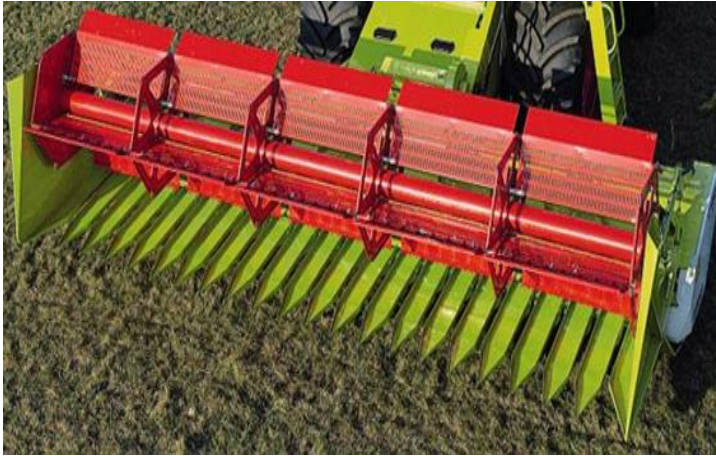
Obrázek II-8 Adaptér pro sklizeň slunečnice, dostupné na http://www.claas.de [19]
