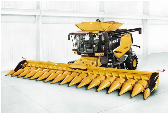
Obrázek II-7 Adaptér pro sklizeň kukuřice na zrno, dostupné na http://app.claas.com [5]
