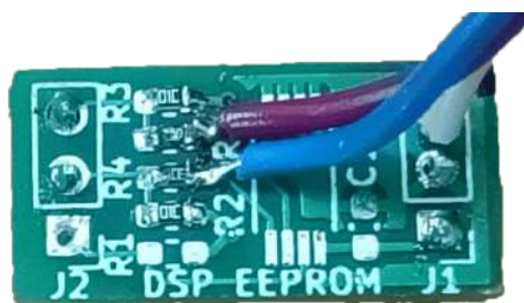
Obr. 2.5: Využití desky EEPROM pro I2C komunikaci s deskou CY7C68013A
