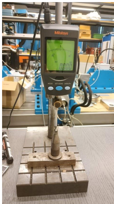
Obr. 3.11 Digitální úchylkoměr Mitutoyo ID-H0530
