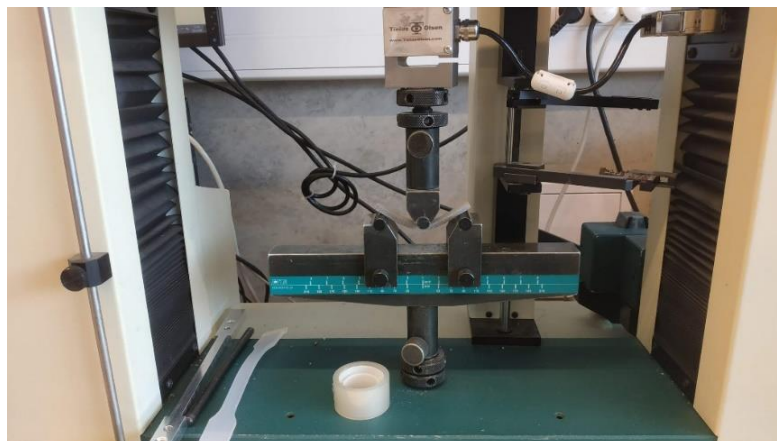
Obr. 3.13 Průběh zkoušky ohybem
