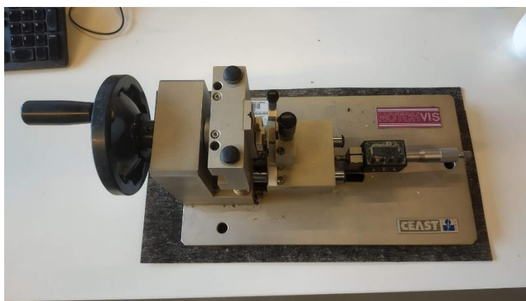
Obr. 3.15 Mechanická vrubovačka Ceast
