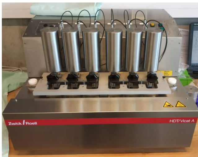
Obr. 3.18 Zkušební zařízení Vicat / HDT
