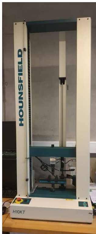
Obr. 3.12 Zkušební zařízení Hounsfield H10KT
