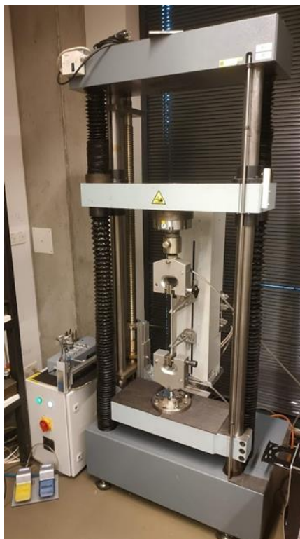
Obr. 3.10 Trhací zařízení TiraTest 2300
