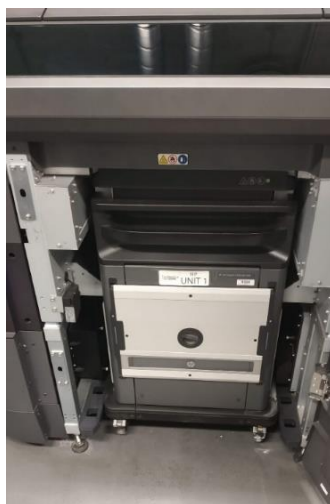
Obr. 3.5 Zavezení výrobní jednotky do 3D tiskárny
