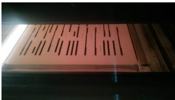
Obr. 3.6 Průběh 3D tisku technologií MJF
