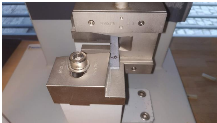
Obr. 3.17 Umístění zkušební tělesa na podpěry
