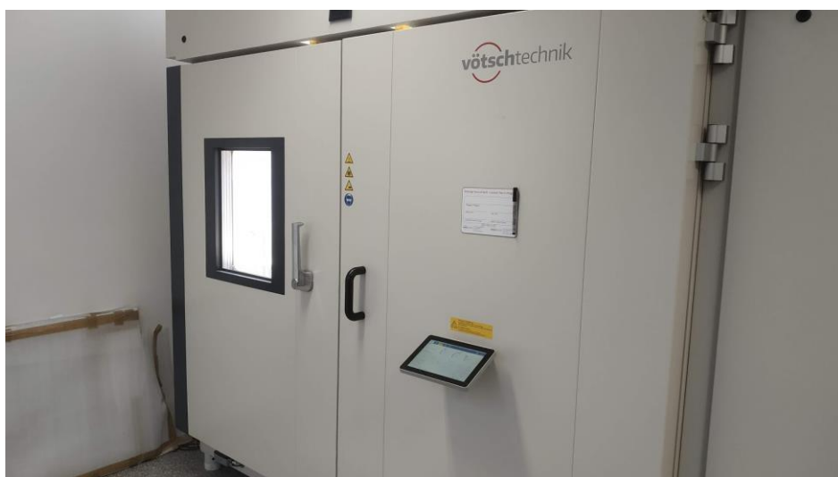
Obr. 3.8 Solární klimatická komora
