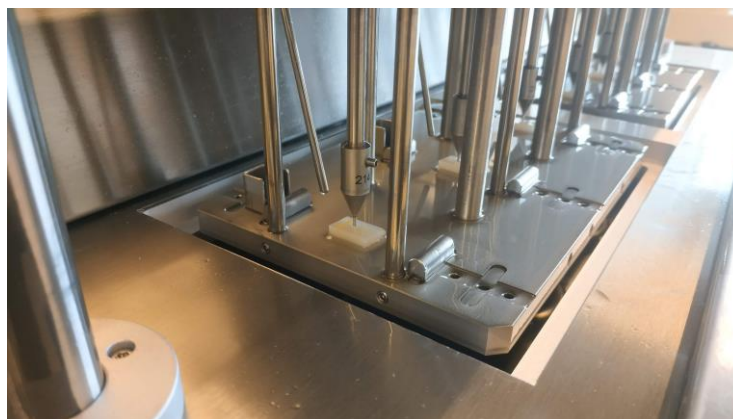
Obr. 3.19 Zkušební těleso zatížené jehlou
