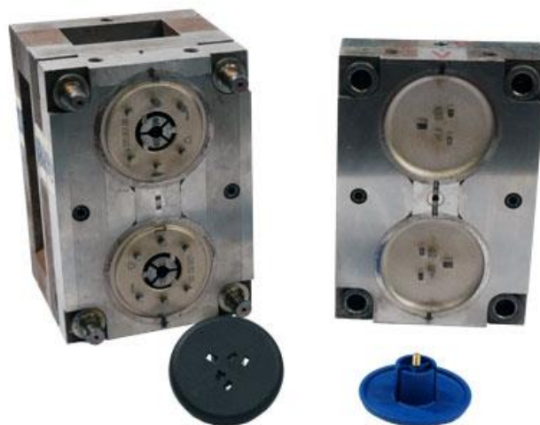
Obr. 2.7 Ukázka vstřikovací formy včetně výstřiků [22]
