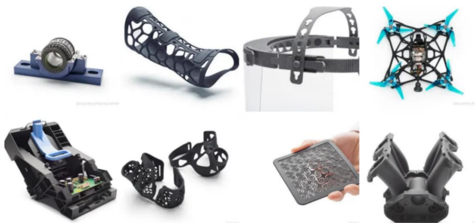
Obr. 2.4 Výrobky zhotovené pomocí technologie MJF [2]
