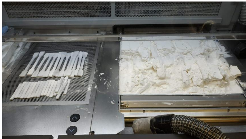
Obr. 3.7 Proces vyjmutí dílů z výrobní jednotky
