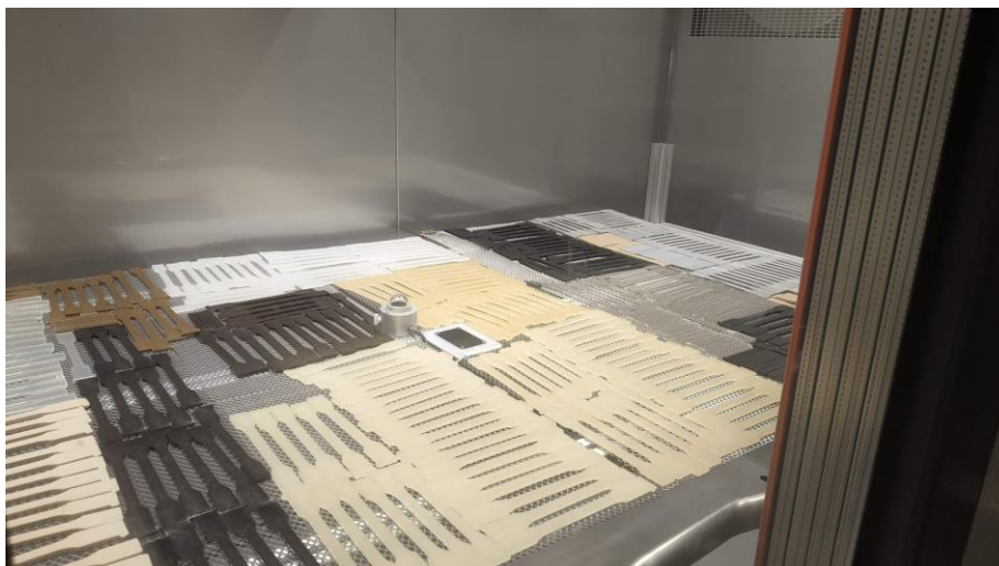
Obr. 3.9 Zkušební vzorky během zkoušky atmosférického (klimatického) stárnutí
