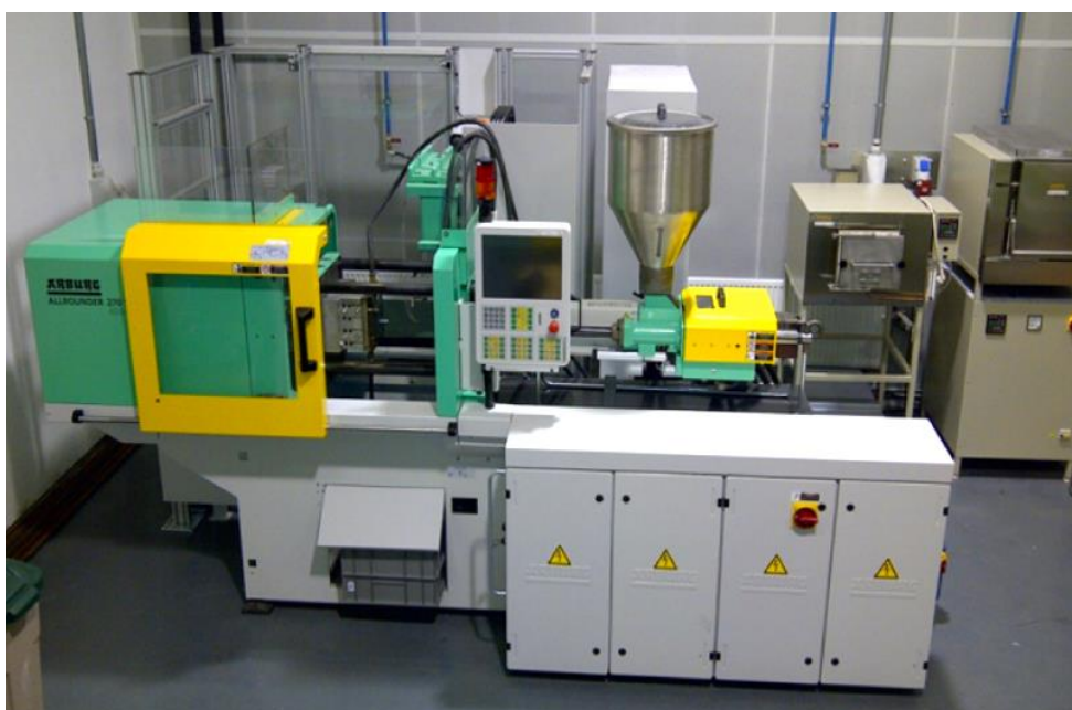
Obr. 3.3 Vstřikovací lis ARBURG 270 S 400-100
