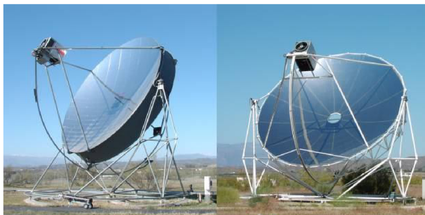
Obrázek 14: Prototyp talířového Stirling systému ve Španělsku. [36]
