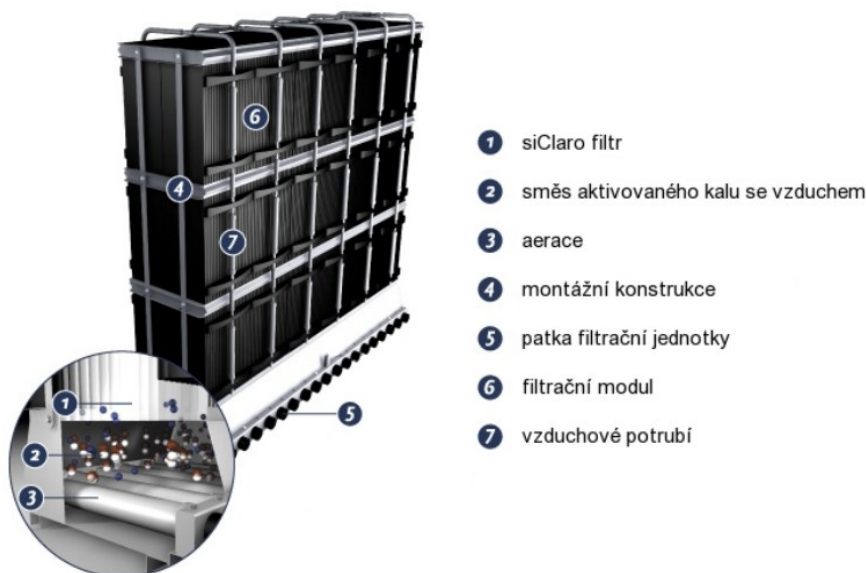
Obr. 11.11 Schéma membránového modulu siClaro [50]
