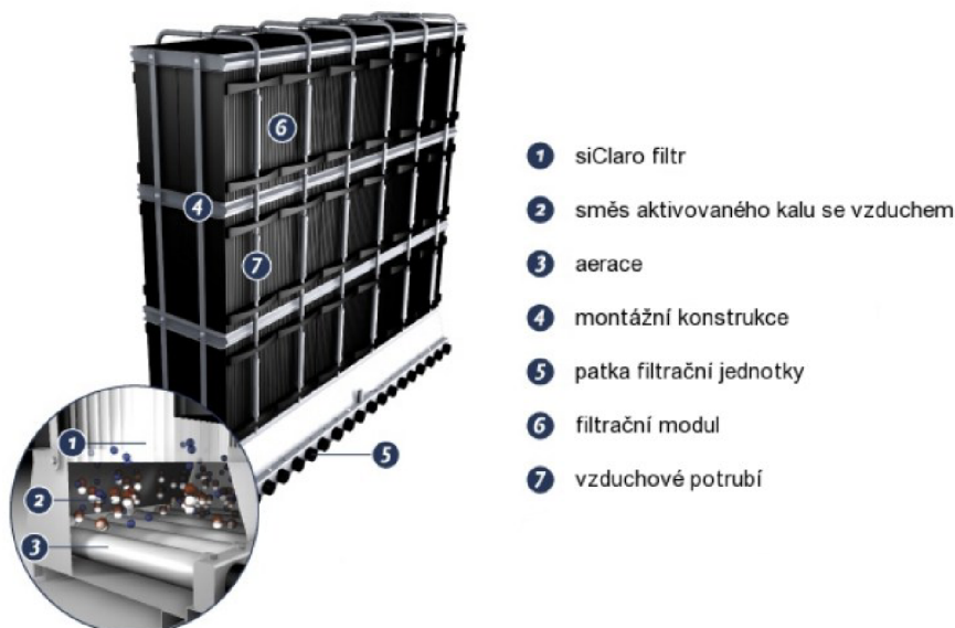
Obr. 11.11 Schéma membránového modulu siClaro [50]
