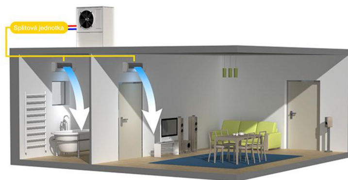
Obr. 20 TČ vzduch/vzduch – vytápění/chlazení místností [61].
